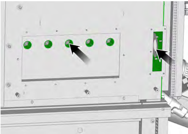
Fig. 2-33: Nettoyage des canaux
