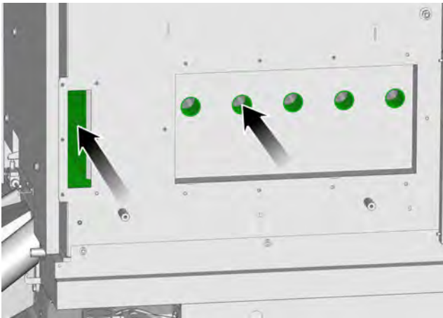
Fig. 2-32: Nettoyage des canaux
